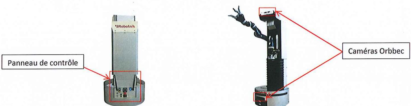
**Logiciel** Le robot utilise « Robot Operating System » (ROS) et Linux. Possibilité de lancement de pilotes pour capteurs et parties mobiles, squelette cinématique, visualisation du modèle 3D, téléopération, surveillance (monitoring) des parties intérieures, simulation physique 3D.
